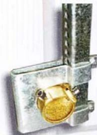
Αποτελείται από την κρεμαριέρα, το εξάρτημα φωλιά και το γρανάζι. Χρησιμοποιείται σε μεταλλικούς σκελετούς για να ανοιγοκλείνει παράθυρα οροφής ή πλευρικά και σε μεταλλικούς σκελετούς μέσω του κατάλληλου μοτέρ.
